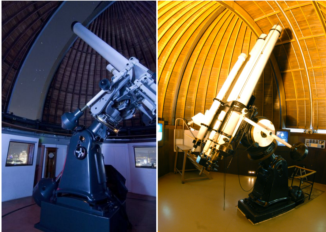
Obrázek 3.3: „Dvojčata“ z Zeissových závodů: 30 cm refraktor na renovované montáži v Urania Sternwarte v Curychu ( vlevo ) a dvojitý 18 cm a 20 cm refraktor na (dosud nerenovované) montáži v Hlavní kopuli Štefánikovy hvězdárny ( vpravo ). Zdroj: Urania Sternwarte Zurich a HaP hl. m. Prahy.
