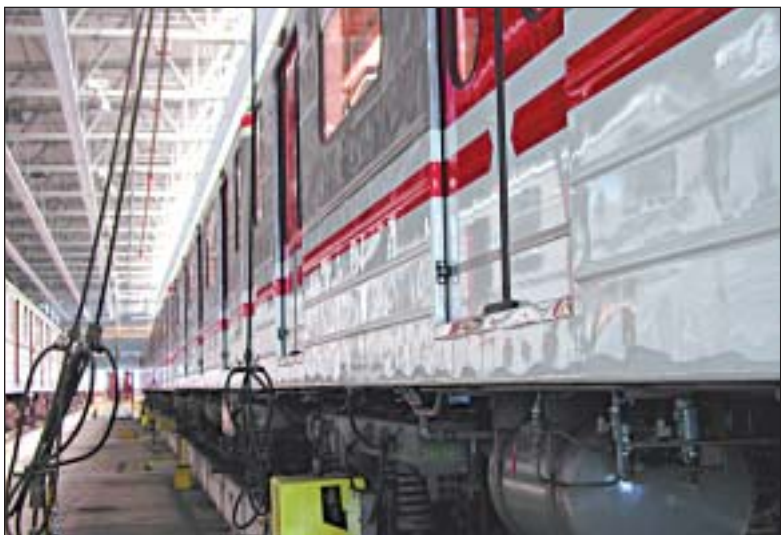
I z tohoto snímku je patrné, že Sověti neuměli vyrobit rovný plech. A to jsou prý pod vrstvou laku místy i centimetrové nánosy kytu... Foto: Pavel Ryjáček
