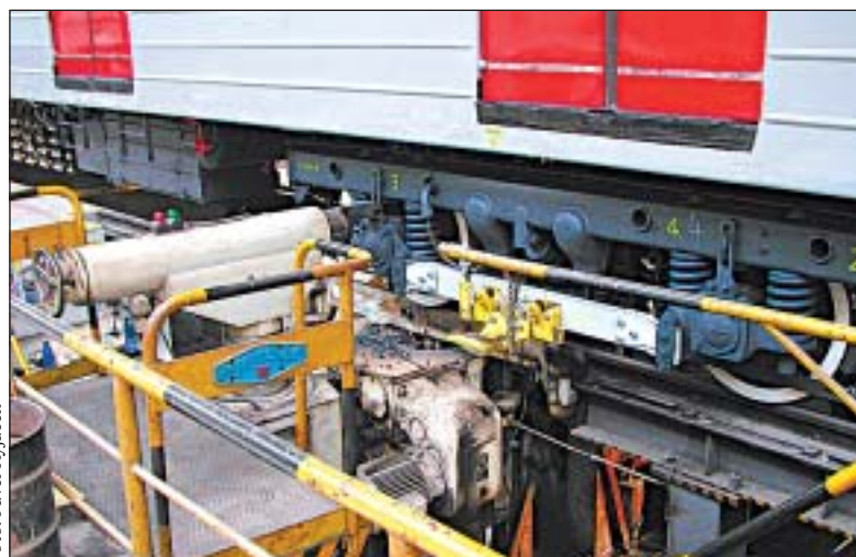
Výtečný pomocník: stroj, který přesoustruží kola, aniž by se musela odmontovávat. Foto: Pavel Ryjáček
