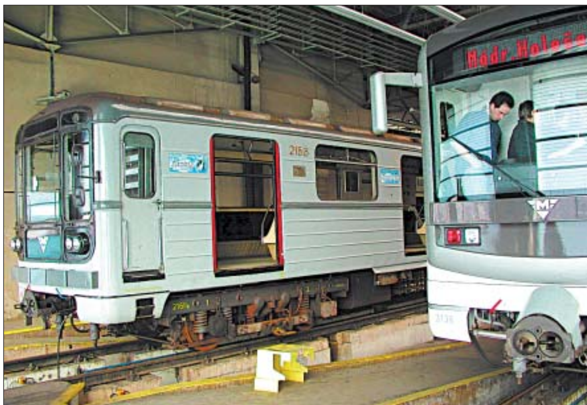
Na nejstarší trati, tedy na „céčku“, už jezdí 22 úplně nových souprav. Krom toho tu potkáte sedm modernizovaných a zatím i 4 „pravé ruské“. Ty ovšem v průběhu letoška skončí. Rozdíl mezi původní a modernizovanou verzí je značný – z ruského vozu zbyde vlastně jenom karoserie a podvozek s elektromotory. Upravený vůz je lehčí o 1,5 tuny, úspornější a bezpečnější. Foto: Pavel Ryjáček
