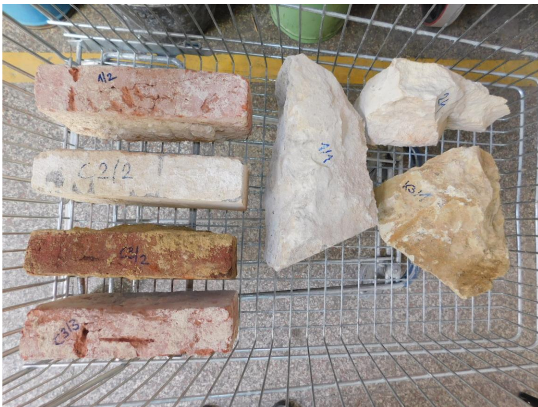
Foto 69 – Celkový pohled na odebrané vzorky zděných prvků – opuka, betonová cihla, plná pálená cihla
