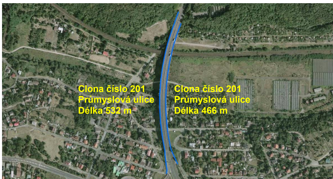
Obr. 16 Situace clony na mostě na Průmyslové ulici
